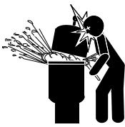
ESTE FILTRO FUNCIONA A ALTA PRESIÓN. CUANDO SE LE DA SERVICIO A ALGUNA PIEZA DEL SISTEMA DE CIRCULACIÓN (POR EJEMPLO: ABRAZADERA, BOMBA, FILTRO, VÁLVULAS, ETC.), PUEDE ENTRARLE AIRE AL SISTEMA Y PRESURIZARSE. EL AIRE PRESURIZADO PUEDE VOLAR LA TAPA, LO QUE PODRÍA DAR POR RESULTADO UNA LESIÓN GRAVE, LA MUERTE O DAÑOS A LA PROPIEDAD. PARA EVITAR ESTE POSIBLE RIESGO, SIGA ESTOS INSTRUCTIVOS.
