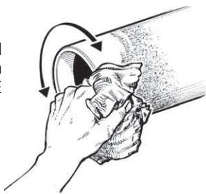
4. Revise la penetración y ablandamiento raspando las superficies que contienen el Primer. Unas milésimas de la superficie semi-fluida deben ser removidas fácilmente. Repita la aplicación del Primer si es necesario.
