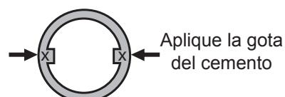
1. Para posicion cerrada solamente (evite que la válvula sea cerrada en la posición abierta): cemente el anillo de cerradura en el torre del vástago del cuerpo con las aletas alineadas con la línea de la válvula y de la tubería.
