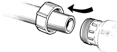
**PASO 4** Coloque los empaques de hule sobre extremo de la tubería. Extremidad: humedezca la tubería con agua limpia para ayudar a la asamblea. No utilice los lubricantes.
