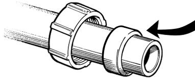
**PASO 5** Ensamble la tubería y el empaque al cuerpo de válvula firmemente insertando ambas partes en el para cementar. Deslice la tuerca de union encima del empaque para unir las roscas. Apriete con la mano solamente.
