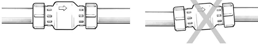
**PASO 7** Utilice la llave de la tuerca de la compresión de SPEARS® o la llave de correa comercial disponible solamente. No utilice las llaves convencionales de la tubería que pueden dañar los materiales plásticos. Apriete las tuercas firmemente con la mano a aproximadamente de 1/4 a 1/2 vuelta. El esfuerzo de torsión medio debe ser aproximadamente de 25 pie-libras en tamaños de la válvula de 1/2 a 2 pulgadas.
