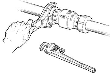
**PASO 8** Sistema de la prueba de presión solamente después que todas las juntas se han apretado correctamente.
