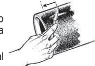
3. Aplique una segunda capa al conector de la válvula y al tubo.
