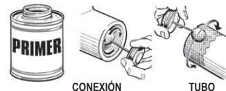
2. Aplique el Primer al tubo de la misma manera, extendiendo el área de aplicación un poco más de la profundidad de la inserción de la conexión.
