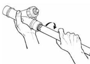
**PASO 2** Ensamble de la junta - 1 a 2 vueltas más allá del "apriete con los dedos" es generalmente todo lo que se requiere para hacer una conexión roscada firme.
