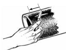
Compruebe la penetración y el ablandamiento raspando las superficies preparadas. Algunos milesimos de la superficie semi-líquida serán fácilmente quitado.
