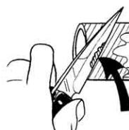
Revise la penetración y ablandamiento raspando las superficies que contienen el Primer. Unas milésimas de la superficie semi-fluida deben ser removidas fácilmente.
