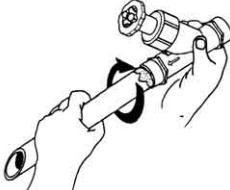
Apretar INECESARIAMENTE puede dañar la rosca del tubo o de la válvula.
