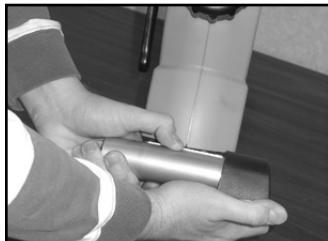
3. A l'aide d'une simple pression, insérez les pieds moulés avant dans le pied support avant.
