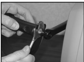
6. Inserire le filettature del pedale destro nella pedivella di destra e utilizzando l'apposita chiave ruotare il pedale in senso antiorario fino allo scatto in posizione. Ripetere la stessa operazione per il pedale sinistro.
