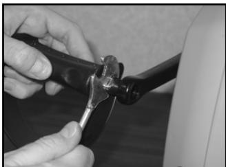
6. Insira os encaixes do Pedal Direito na Manivela do Pedal Direito, e com uma chave-inglesa, gire no sentido dos ponteiros do relógio até que esteja bem apertado. Repita o mesmo processo com o Pedal Esquerdo.
