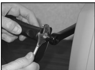
6. Monter højre pedals gevind på den højre pedalkrank og med skruenøglen drejes det med uret, indtil det slutter til. Gentag for venstre pedal.
