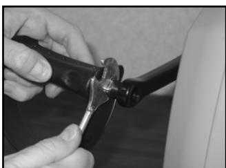
6. För in gängorna på höger pedal i den högra pedalarmen och skruva den moturs med nyckeln tills den är åtdragen. Upprepa denna process med vänster pedal.
