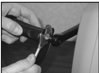
6. Steek de Schroefdraden van de rechterpedaal in de rechterpedaalkruk en draai met de inbussleutel linksom totdat die vast zit. Herhaal dit voor de linkerpedaal.
