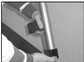
2. Drücken Sie die hinteren Profilfüße in den hinteren Stützfuß.
