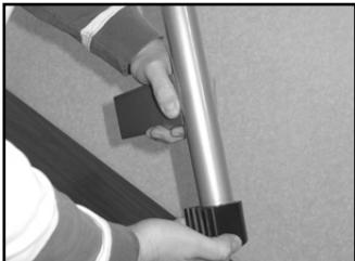
2. Sæt den bagerste, formstøbte fod fast på det bagerste støtteben.
