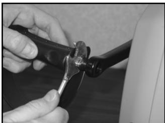
6. Insertar las roscas del Pedal Derecho en la Manivela del Pedal Derecho, y con una llave inglesa, girar en el sentido contrario a las agujas del reloj hasta que esté apretado. Repetir este proceso para el Pedal Izquierdo.
