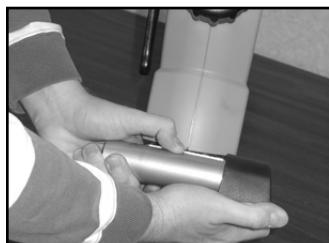
3. Skjut den främre gjutna foten på det främre stödbenet.
