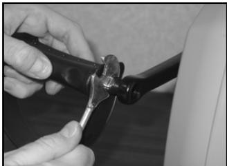
6. Insérez les manivelles de la pédale droite dans le pédalier droit et, à l'aide d'une clé, tournez-la dans le sens des aiguilles d'une montre jusqu'à ce qu'elle soit bien fixée. Répétez la même procédure pour la pédale gauche.
